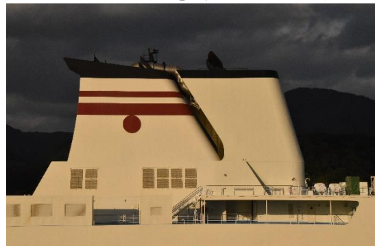
「いずみ」の煙突の前には、二酸化窒素を除去するスクラバーが取り付けられていました。
